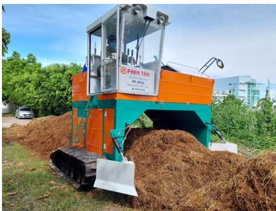
Hình 1. Cơ giới hóa đảo trộn luống ủ
